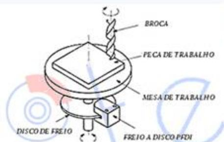
NO EXEMPLO À ESQUERDA, O FREIO A DISCO É MONTADO EM CONJUNTO COM UM DISCO DE FREIO INDEXADO NUMA MESA/BASE DE FURAÇÃO.
