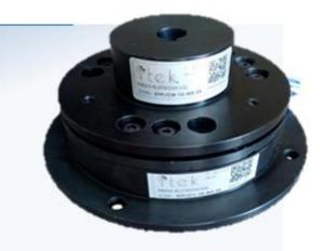
ESSE MODELO É "NA" (NORMALMENTE ABERTO), OU SEJA, QUANDO RECEBE SINAL DE ACIONAMENTO, O ESTATOR (FIXO) ATRAI O DISCO DE ATRITO (DO SCJ ROTATIVO) ATRAVÉS DA FORÇA ELETROMAGNETICA, REALIZANDO A FRENAGEM DO EIXO MOVIDO.
